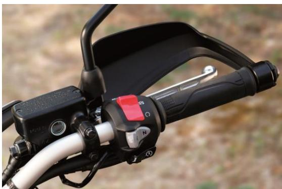
Mit dem rechten Daumen wird analog zum PKW „D“ oder „S“ (Sport) per grauem Tastschalter eingelegt. Das Einlegen des 1. Gang ist sowohl akustisch als optisch über die Anzeige im Display zu verfolgen. Gespannt bin ich auf den ersten Anfahrvorgang. Die linke Hand zuckt kurz, weil eine Funktion für diese Hand nicht mehr vorgesehen ist. Auch beide Füße können auf dem Boden bleiben. Die Gänge werden bei DCT Getriebe automatisch bzw. wahlweise über Tasten am linken Handgriff gewechselt.
