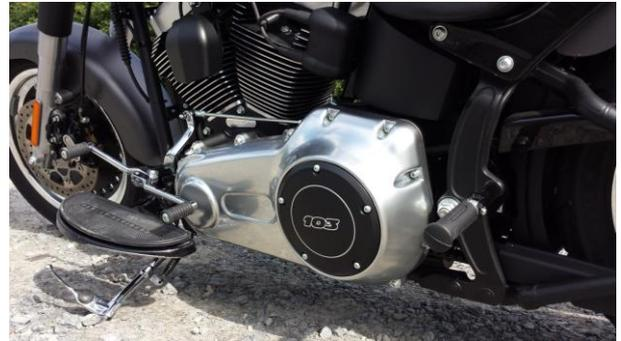
Die Fat Boy Special verfügt über den bekannten 103B Motor, dessen beide Zylinder sich auf einen Hubraum von 1.690cm<sup>3</sup> ergänzen und die im Falle der Fat Boy 58kW/79PS aus dem Gehäuse schütteln. Beeindruckend sind die Drehmomentwerte, die sich bereits ab Standdrehzahl versammeln und ihren Höhepunkt von 133Nm bereits bei 3.250min<sup>-1</sup> preisgeben. Der nicht ganz 19 ltr. fassende Tank sollte regelmäßig für deutlich mehr als 300KM Reichweite reichen.
