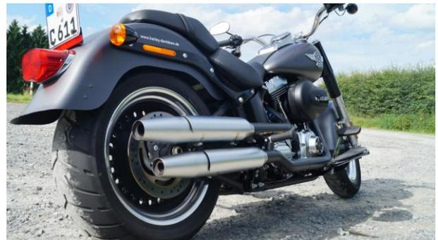
Wären nicht die Lastwechselreaktionen bei niedrigen Drehzahlen, so würde man den Hubraumriesen möglicherweise ausnahmslos in der 6. Fahrstufe zirkeln. Der 1. Gang lässt sich und erst recht nicht im kalten Zustand geräuschlos einlegen. Ansonsten gestaltet sich die Bedienung des Getriebes über die Schaltwippe angenehm.
