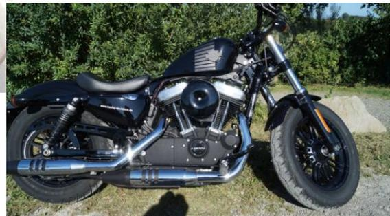
Die ballonförmigen Reifen sind exklusiv von Michelin für Harley Davidson hergestellt. Die Forty-Eight 2016 verfügt bereits über die stabileren Standrohre von 49mm Durchmesser und die Möglichkeit zur Vorspannung der hinteren Federn, dennoch ist der Fahrkomfort eher für gut ausgebaute Straßen ausgerichtet.
