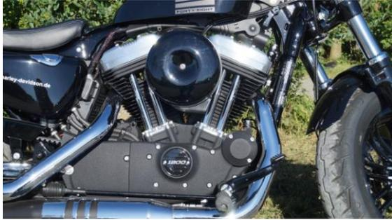
96Nm Drehmoment und dies bereits bei 3.500min-1 ist typisch für die V-Motoren aus Milwaukee. Da die PS Angabe für die amerikanischen Weiten eine deutlich untergeordnete Rolle spielt bekomme auch ich aufgrund der nur 57PS absolut kein schlechtes Gewissen.
