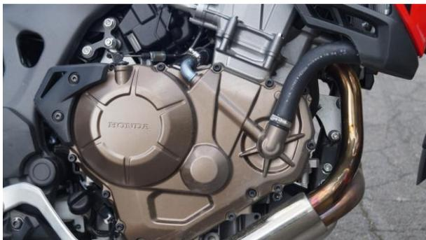
Zur neuen Africa Twin ist aus dem 2Zyl. V ein 2 Zyl. Reihenmotor, quer zur Fahrtrichtung mit 1.000 Kubik geworden. 70kW/95PS sind moderate Leistungsdaten aber Leistungsdefizite sind bei mir keine aufgekommen. Grund dafür ist die Quirlichkeit
