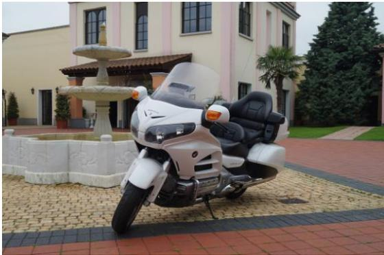
Genau 421 kg vollgetankt incl. Navigation und Airbag, verteilt auf einer Länge von 2.630mm und Breite von 945mm verlangen Respekt. Die unter der walkürehaften Verkleidung versteckte Bereifung 130/70R18 (vorn) und 180/60R16 (hinten) wirkt für heutige Verhältnisse eher minimalistisch.
