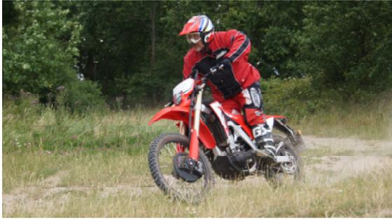
Der leicht auf 7,6 ltr. vergrößerte Tank der Straßenversion sollte locker für ein 100KM Etappe mit leichten Offroad-Einsatz reichen. Die Federelemente von Show sind vorn in Federvorspannung und Druckstufe und hinten voll, also auch noch in Zugstufe einstellbar und waren auch bei höherem Tempo und dies auch mit meinem nicht mehr voll im idealen BMI tauglichen Bereich tätigen Körper nicht an die Grenzen zu bringen.
