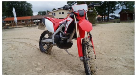
Die Bereifung vorn/hinten entspricht mit 21/18 Zoll großen Felgen gängigen Enduro Reifenkombinationen und weicht aus diesem Grund geringfügig von 19“ Hinterrad der R Version ab.
