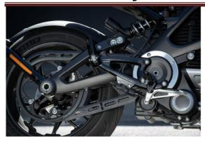
Die Lagerung der Hinterradschwinge bietet gleichzeitig den Drehpunkt des Sekundärantriebs mittels Zahnriemen.
