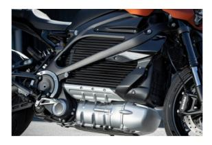
Herzstück der LiveWire ist der unten liegend positionierte Dreiphasen-Permanentmagnet Elektromotor, der mit der darüber verschraubten Batterieregelungseinheit in einem verschraubten Aluminium Brückenrahmen eingefasst wird. Das Lenkkopflager und auch der Heckrahmen sind verschraubt.
