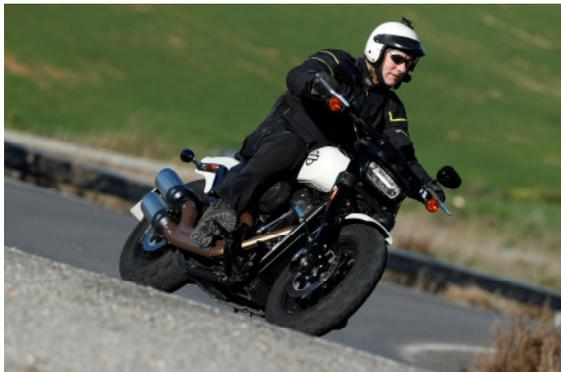
Die Fat Bob erkennt man an von vorn an dem breiten LED Strahler sowie den fetten Bereifung in der Dimension 150/80 (vorn) und 180/70 (hinten) auf jeweils 16Zoll Leichtmetall-Gusspeichenrädern.
