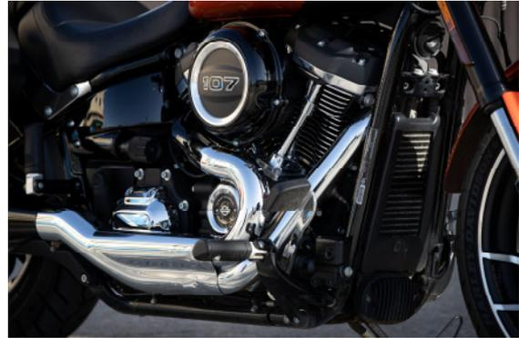
Der 1.745 Kubik große Milwaukee-Eight V-Twin mit 62kW/84 PS Leistung sowie einem Drehmoment von 145Nm atmet über eine 2inEins Auspuffanlage aus. Die Rücklichter sind dezentral in die Blinkergehäuse integriert.
