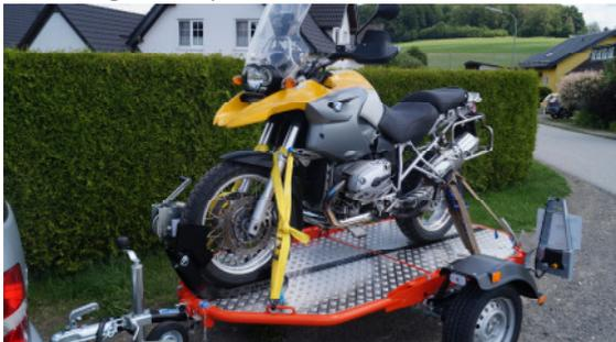
Der Cochet UNO wird zum Be- und Entladen mechanisch über einen Seilzug abgesenkt, dass die Anschaffung und das Hantieren mit Auffahrrampen entbehrlich ist.
