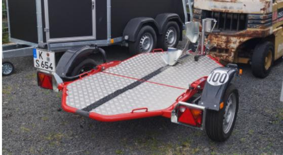
Im Wesentlichen besteht der Cochet UNO aus einem Plateau aus einem geschweißten Rohrrahmen mit Alu Riffelblechauflage.
