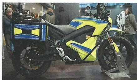
Der Elektromotor dieser Kräder leistet 45kW/60PS und bietet eine Höchstgeschwindigkeit von 154km/h. Er liegt damit in einer vergleichbaren Größenordnung mit dem ehemaligen „bayrischen“ Einzylinder.
