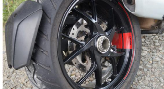
Die 1260 S GT steht auf einer 17 Zoll Bereifung. Im Heck ist eine massive Leichtmetallschwinge verbaut. Die Vorderradachse ist nur minimal aus der Standrohrmitte nach vorn versetzt, was ein sehr direktes, vielleicht sogar etwas kippeliges Ansprechverhalten bei sehr langsamer Fahrweise verursacht. Mit zunehmenden Rotationskräften liegt die Multistrada dermaßen stabil, dass ich mir kleineres Schuhwerk wünschen würde, welches nicht so verschleißträchtig die Kurvenradien nachmisst.
