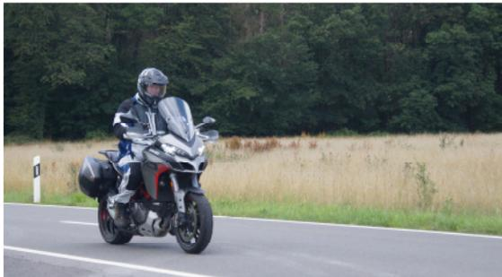
Im Fahrbetrieb macht der 1.260er Motor seiner favorisierten Drehzahl oberhalb von 3.000 Umdrehungen keinen Hehl. Bei innerstädtischen Geschwindigkeiten ist eher der 3. denn der 4. Gang gefragt. Das sauber zu schaltende Getriebe macht es dem Fahrer leicht in Spitzkehren sogar bis auf den 1. Gang runter zu gehen. Über dieser Drehzahlgrenze oder erst recht oberhalb von 5.000min<sup>-1</sup> zeigt der Italiener, wo der Papst die Locken hat. Dann geht's ab, als wenn es keinen Morgen
