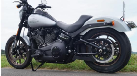
Die Starrrahmenoptik des Softtail-Modell gepaart mit dem leistungsstarken 114 Kubik Inch Milwaukee Eight Triebwerk, welches aus 1.868 Kubik eine Leistung von 69kW / 94 PS schüttelt und bereits bei 3.000 Touren ein Drehmoment von 155 Nm anbietet.
