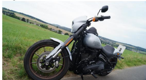
Gegenüber der normalen Low Rider bietet die S-Version eine Doppelbrems Scheibe am Vorderrad und einen leicht auf 28° reduzierten Lenkkopfwinkel für ein Mehr an Handlichkeit.
