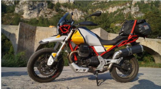
Ganz klassisch punktet die TT mit einem 90° V2 dessen Kurbelwelle in Fahrrichtung auf ein 6Gang Getriebe stößt und die Kraft von 59kW/80PS über eine Kardanwelle ans Hinterrad leitet. Der Motor ist traditionell Luft gekühlt und ihm reichen auch konventionell 2 Ventile pro Zylinder um 80Nm Drehmoment zu erzeugen.
