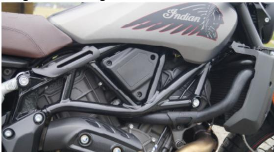
Der im Gitterrohrrahmen integrierter 13 Liter Tank bietet eine Reichweite von knapp 250KM
