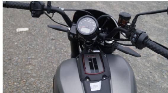
In die runde Mono-Tachoeinheit sind alle Fahrerinformationen zumindest wahlweise alternativ integriert. Der Zündschlüssel ist ein wenig versteckt in der Tankabdeckung nahe dem Lenkkopflager platziert.
