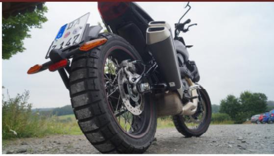
Herzstück der FTR ist ein 1203 Kubik großer V2 mit 60 Grad Zylinderwinkel. Dieser bietet 88kW/120PS sowie ein Drehmoment von 115Nm. Vom Temperament her ist dies ein echter Dampfhammer mit Kraft aus dem Drehzahlkeller, der aber auch bis über 8.000 1-min drehen kann, aber selten muss. Kupplungs- und Bremsbefehle werden hydraulisch umgesetzt, die Gasannahme erfolgt digital (Drive by wire).
