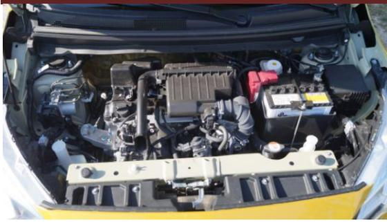
Motorisiert ist der Space Star mit einem 3Zyl.-Benzinmotor, der aus 1.2 Liter 52kW/71PS schöpft und ein Drehmoment von 102 Nm zur Verfügung stellt.
